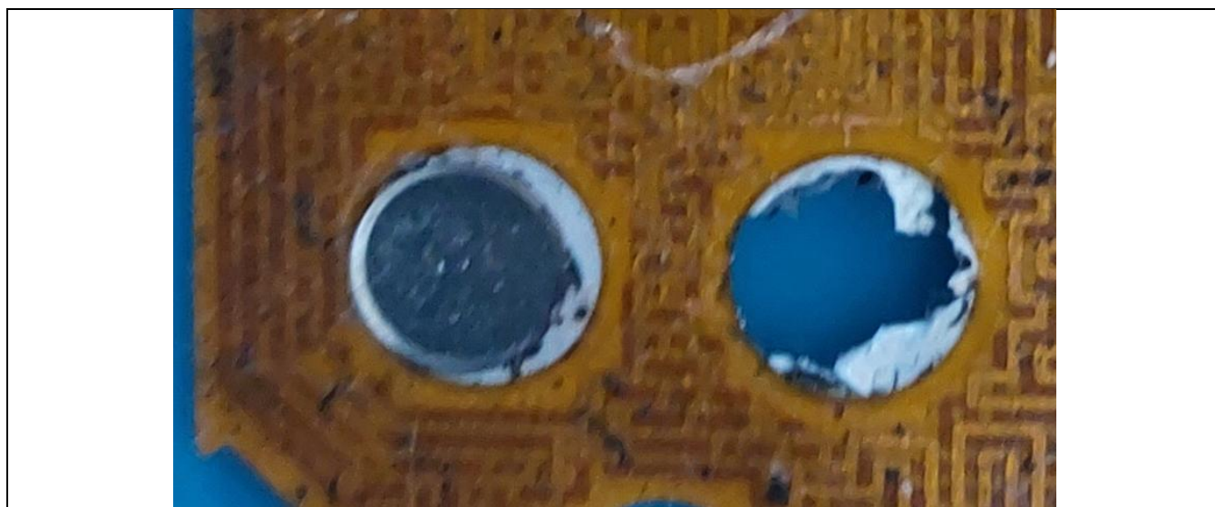
Imagem 1 – Foto ampliada de uma mesh de duplo layer sem proteger os contatos do teclado.
